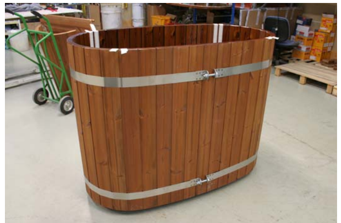
Placera spännbanden på spikarna och dra åt bultarna tills avståndet är cirka 40 mm. När bulten dras åt, knocka med gummihammare för att justera modulerna så att bottenfogen är lika bred hela vägen runt.
