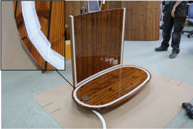
Fäst den första sidomodulen mot botten på utmärkt plats.
